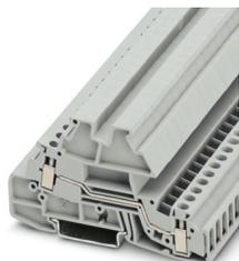
Installationsetagenklemme, Nennspannung: 400 V, Nennstrom: 32 A, Schraubanschluss, 1. und 2. Etage, Bemessungsquerschnitt: 4 mm<sup>2</sup>, Querschnitt: 0,2 mm<sup>2</sup> - 4 mm<sup>2</sup>, Montageart: NS 35/7,5, NS 35/15, Farbe: grau
