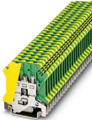
Schutzleiter-Reihenklemme, Bei Anreihung an konturgleiche Durchgangsklemme muss bei Isolationsspannungen > 690 V ein Deckel eingesetzt werden, Anzahl der Anschlüsse: 2, Polzahl: 1, Anschlussart: Schraubanschluss, Bemessungsquerschnitt: 4 mm<sup>2</sup>, Querschnitt: 0,2 mm<sup>2</sup> - 4 mm<sup>2</sup>, Montageart: NS 35/7,5, NS 35/15, NS 32, Farbe: grün-gelb
